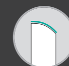
profil obrubníku půlkulatého
